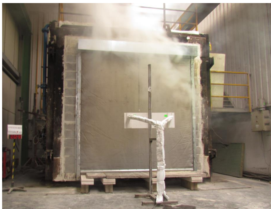
Fotografía 2: Aspecto de la muestra en los momentos iniciales del ensayo.
